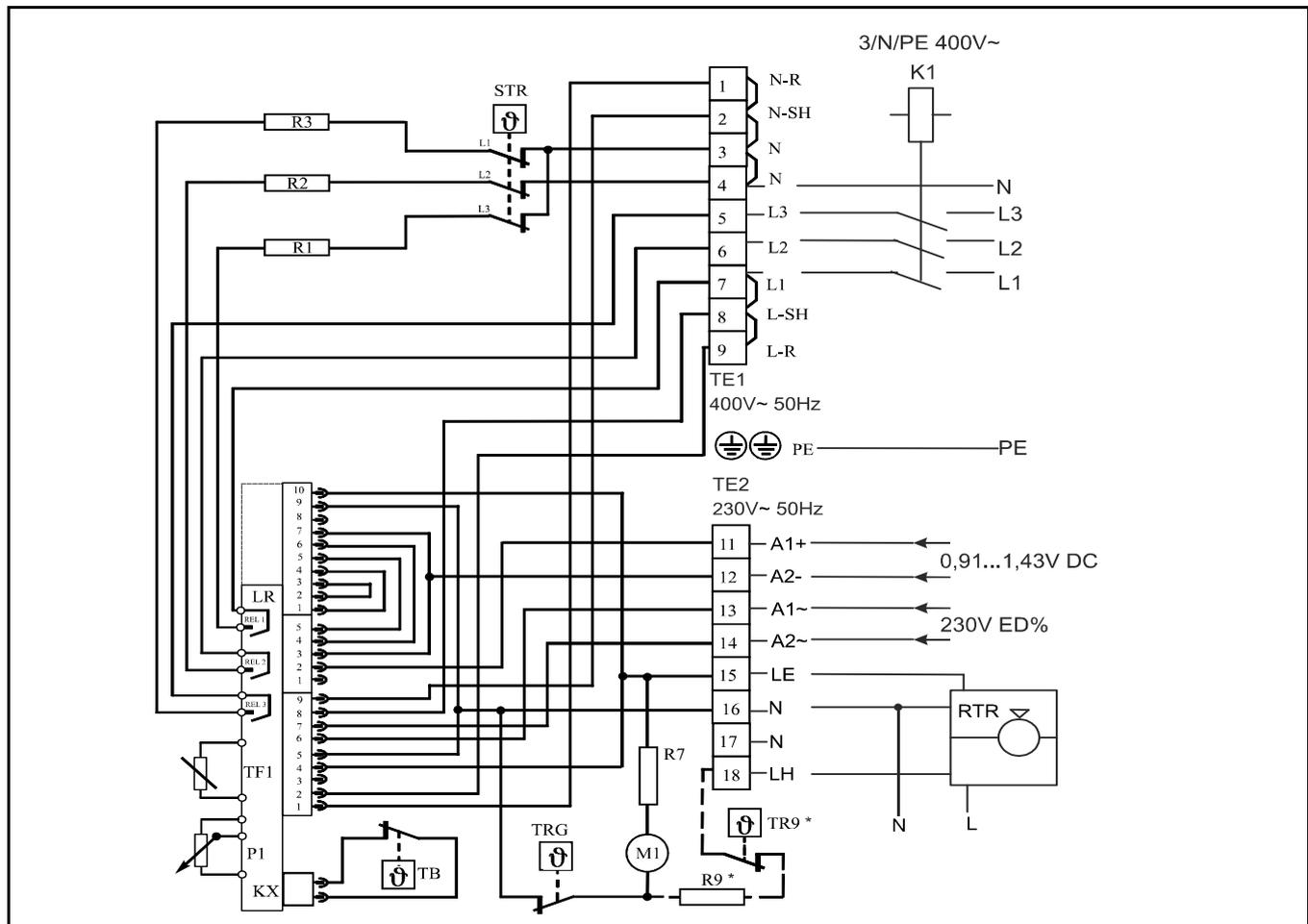
Abb. 22: Elektrischen Anschluss an den Klemmleisten vornehmen.
