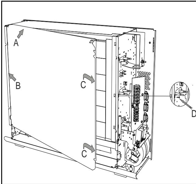
Abb. 18: Kernraumabdeckung einsetzen.
