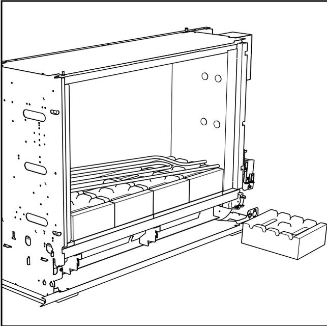
Abb. 14: Heizkörper durch die Öffnungen der Seitenwand-Wärmedämmung einschieben.
